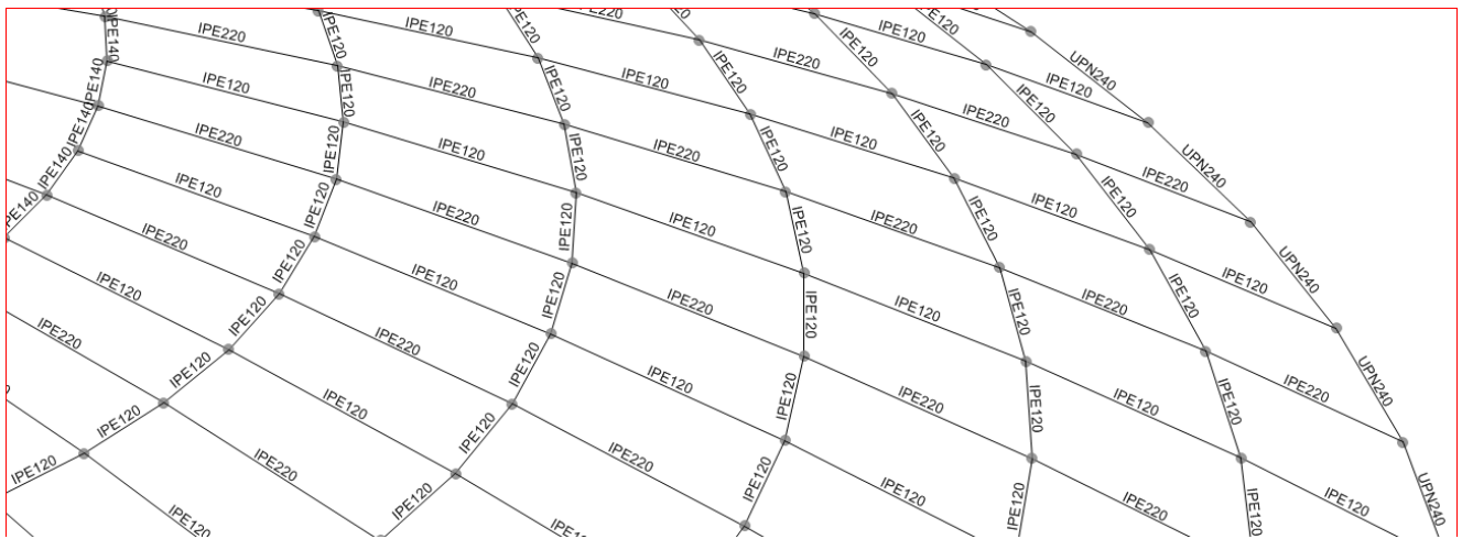
Фиг. 7. Компютърно генерирана схема на покрива на база аналитични пресмятания.
